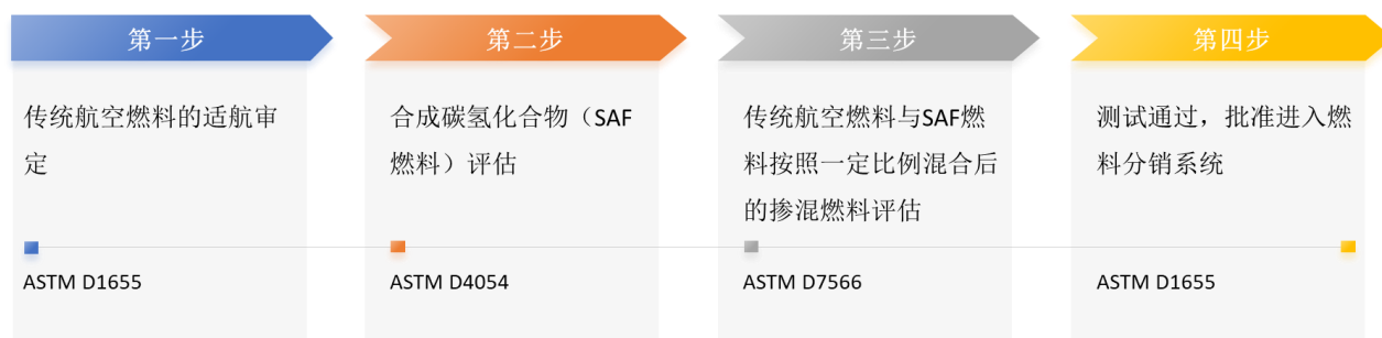
图 40 掺混 SAF 的航空燃料适航审定流程
